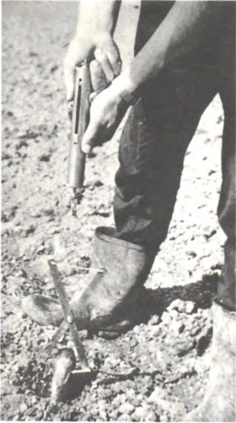
1. De trekkrachtmeter, uitgerust met pen- nen, waarmee de pas gepote stekling uit de grond wordt gelicht.
