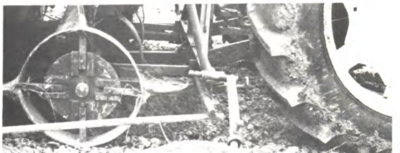
5. Het pootelement, wiel uitgerust met pennen, van de Gastman.
