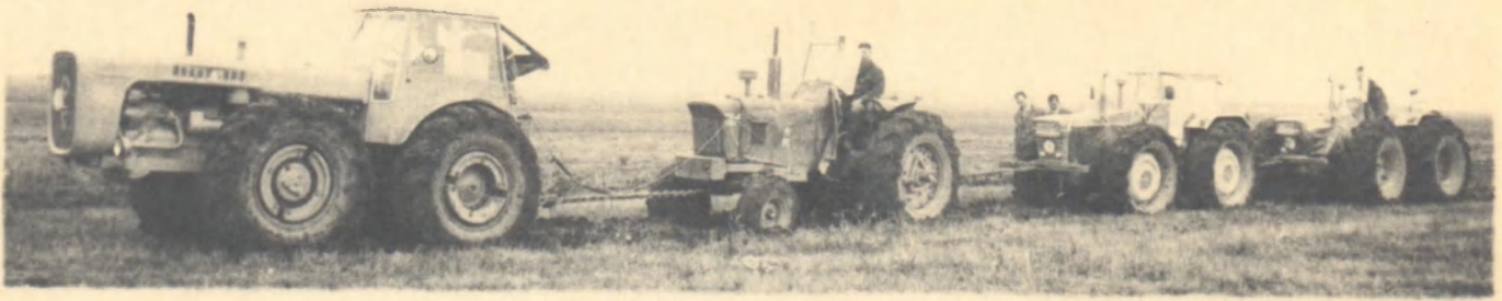
afb. 1 De trekkracht wordt bepaald van de voorste trekker, de drie overige trekkers doen gezamenlijk dienst als afremtrekker.
