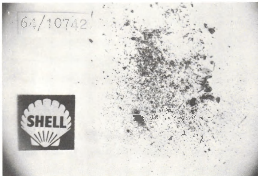
No. 64/10742. SKF 6207 lager uit Claas maaidorser No. 23, links voor (zie bijlage 1), gesmeerd met het stijve vet. Dit is een buitenliggend lager waarin veel water is doorgedrongen. In de vetmassa is vrij veel ijzerroest aanwezig en enig zand met organisch materiaal.
