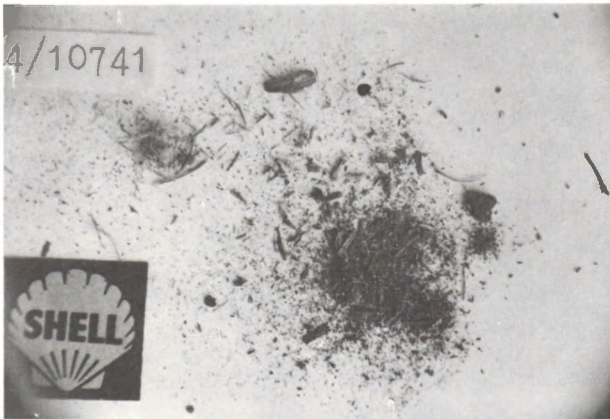
No. 64/10741. SKF 6207 lager uit Clayson maaidorser, schudderlager No. 1 uit machine No. 29 (zie bijlage 3), gesmeerd met het slappe vet. Veel fijn zand en organisch materiaal in de vetmassa, geen corrosie (binnendringen van water in deze, binnen in de machine gemonteerde lagers, is welhaast onmogelijk).
