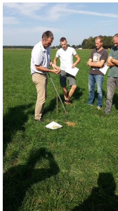
Figuur 4: Op vier plekken waar volgens de dronemetingen verschillen zichtbaar waren, stak Albert Jan Bos met de grondboor monsters op verschillende dieptes en keken we of we de verwachte resultaten zouden zien.
