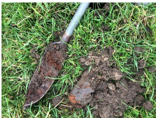
Figuur 14: Veel ijzer in de gemengde bovengrond wijst op periodiek hoge grondwaterstanden en beperking van de draagkracht.
