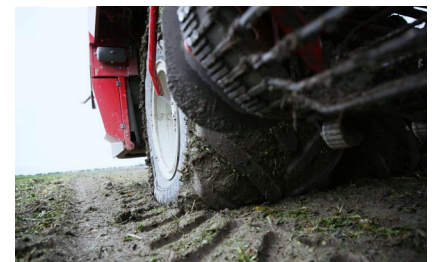
Met VF-bandens onder de rooiër kan de bandenspanning bij alle rooiërs tot ruim onder twee bar dalen, rekening houdend met een cyclische belasting.
