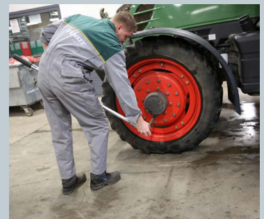
Bij Mecha-Service gebruiken de monteurs een momentsleutel voor het vastzetten van de wielbouten. Hiermee werken ze secuurder dan met de luchtsleutel.
