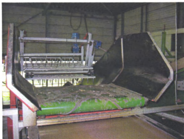
Foto 1 en 2: De 'hark' waarmee de planten op de verwerkingslijn worden gebracht (Foto 1) en de grote band en het snijplateau (Foto 2).
