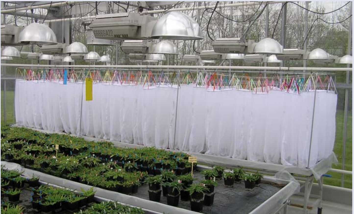
1. Proefopstelling in een kas met gaas dat bladluizen binnen dan wel buiten moet houden. Foto: Gera Hol Experimental set-up in a glasshouse with gauze to keep aphids in and/or out.
