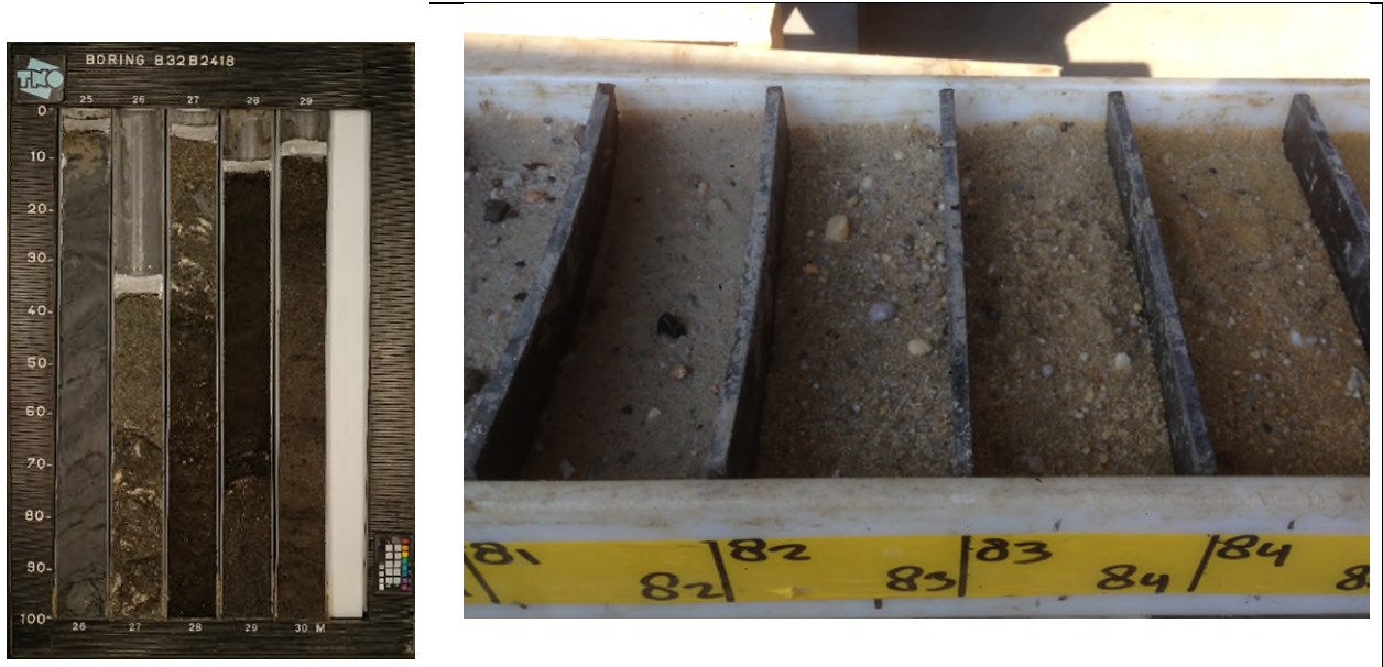
Figuur 10-6 Voorbeeld boormonsterfoto (links, bron: www.dinoloket.n ) en foto van boorbakken (rechts, bron: Rob Breedveld, Vitens).
