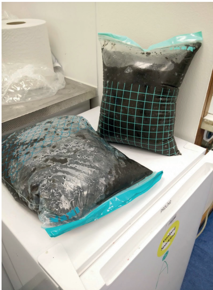
FIGUUR VI.26 THERMFILLY BEHANDELD SLIB IN LUCHTDICHTE ZAKKEN. TIJDENS DE BEHANDELING IS GAS VRIJGEKOMEN WAT NA AFKOELING NOG STEEDS DE ZAK OP SPANNING HOUDT
