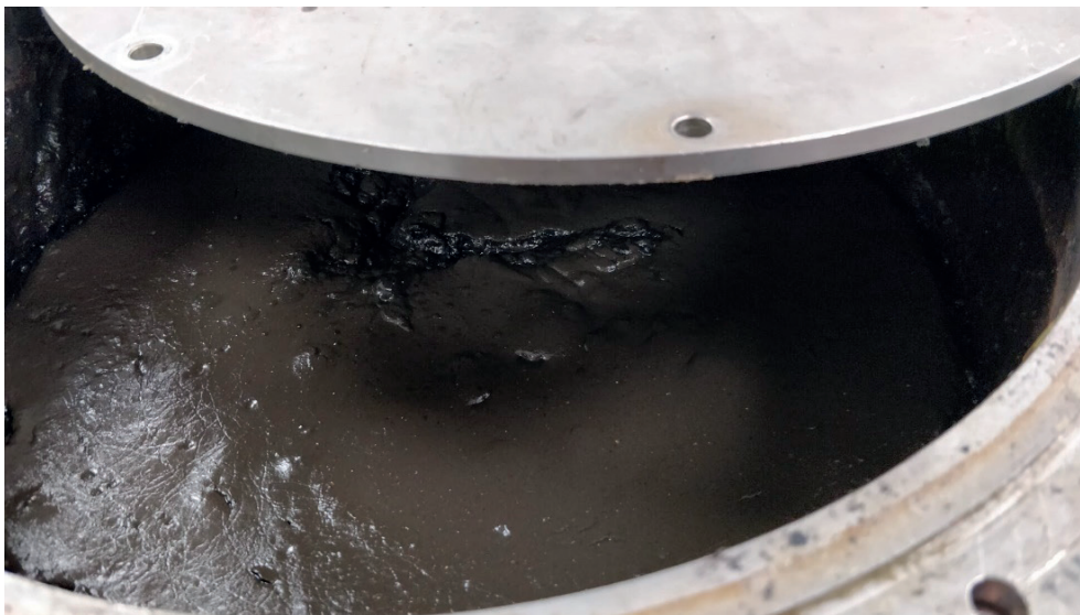
FIGUUR VI.24 ONBEHANDELD SLIB GEMENGD MET GISTINGSLIB IN EEN GEKOELD VOORRAADVAT VERTOOND TEKENEN VAN GASPRODUCTIE EN DIKT IN VAN 6% DS NAAR 9% DS GEDURENDE DE STANDTIJD
