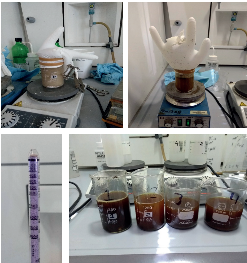
AFBEELDING 2 METINGEN VAN CO 2 (LINKS) EN MONSTERS NA BEHANDELING MET ZUUR (RECHTS)
