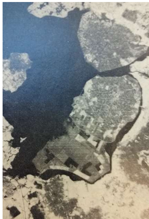
Luchtfoto van Flevoland. Oorspronkelijk beeld door ERTS-1 gescand op 23 maart 1973 om 10.15 op een hoogte van 925 km. Het betreft hier de z.g.n. infrarode band (0.8-1.1 micron). Oorspronkelijke fotoschaal ongeveer 1:1.000.000.
