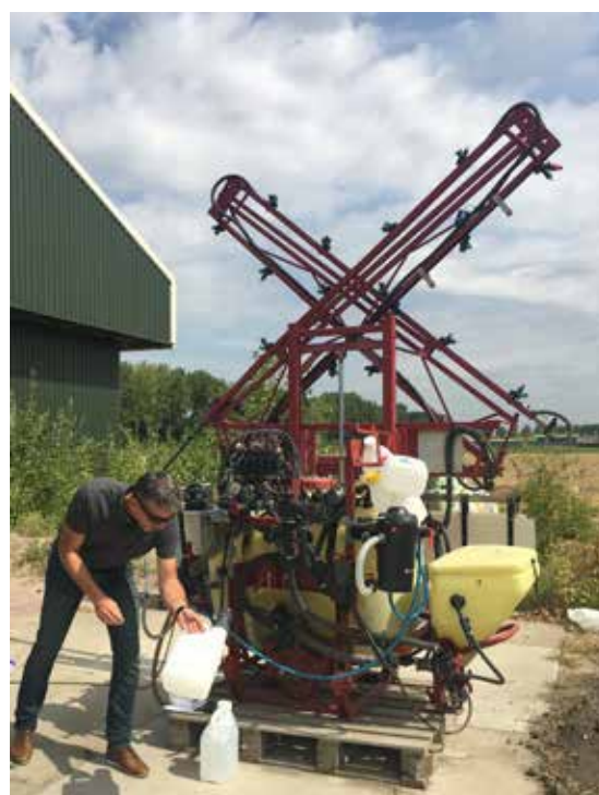
Demonstratie van een gesloten doseer- en reinigingssysteem op spuitapparatuur
