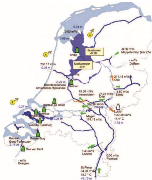
Figuur 9 Voorbeeld van een informatiescherm: Weergave uit het informatiescherm van het hoofdwatersysteem met data over afvoer en chloridegehalte
