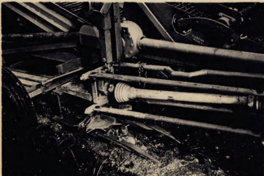
Ontbladerapparaat gebouwd aan BAV-aardappelrooier
