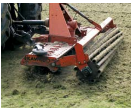
De pistes 'vernieuwen' en vlak maken gaat snel. Daarvoor wordt een rotorkoep met verkruijmelrol ingezet.
