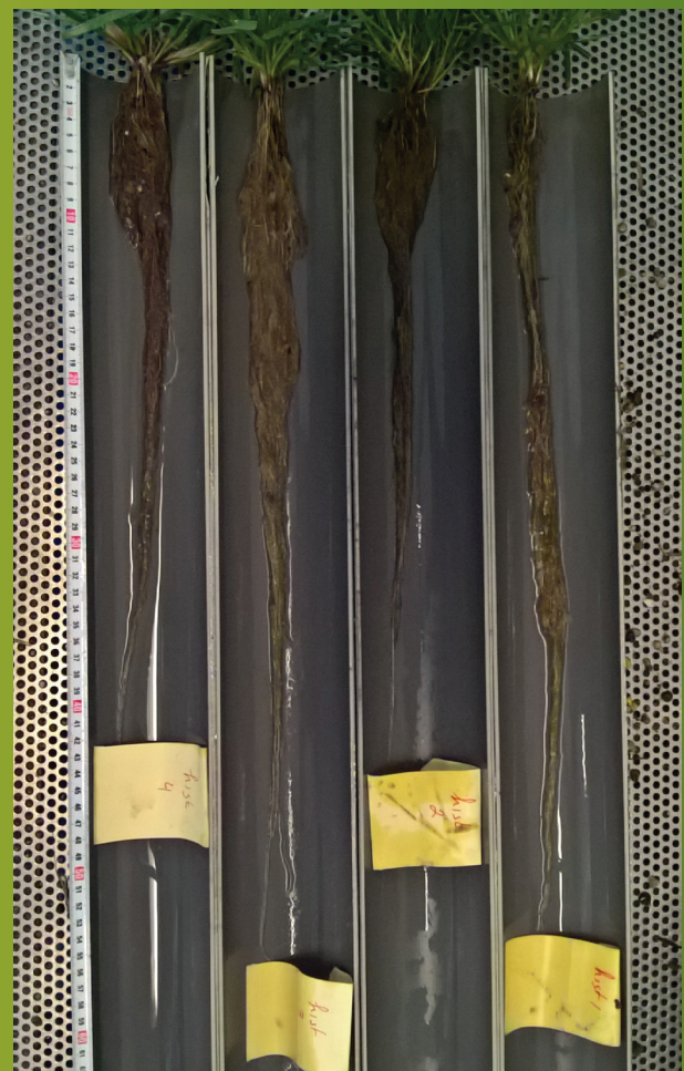
De buizenproef waarmee de verschillen in bewortelingsdiepte tussen verschillende Engels raaigras rassen werden onderzocht
