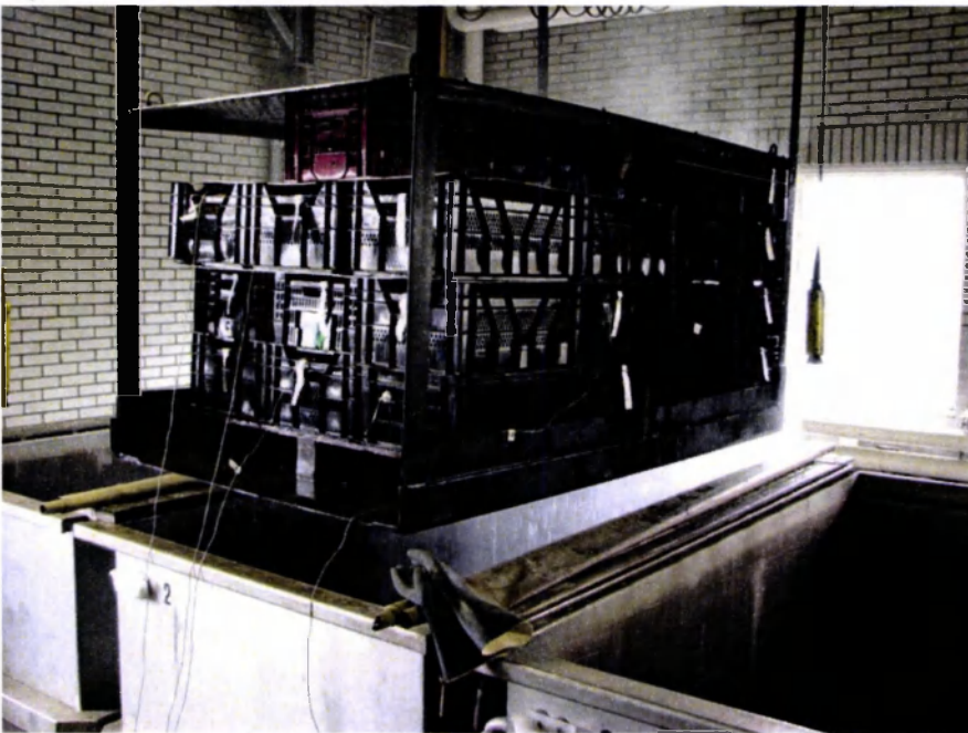
Figuur 1. Opstelling van warmwaterbad na uitvoeren van warmwaterbehandeling
