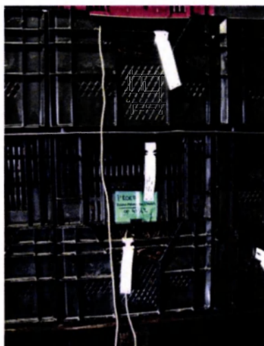
Figuur 3. De temperatuurvoelers werden in de kisten tussen het plantgoed gestoken.
