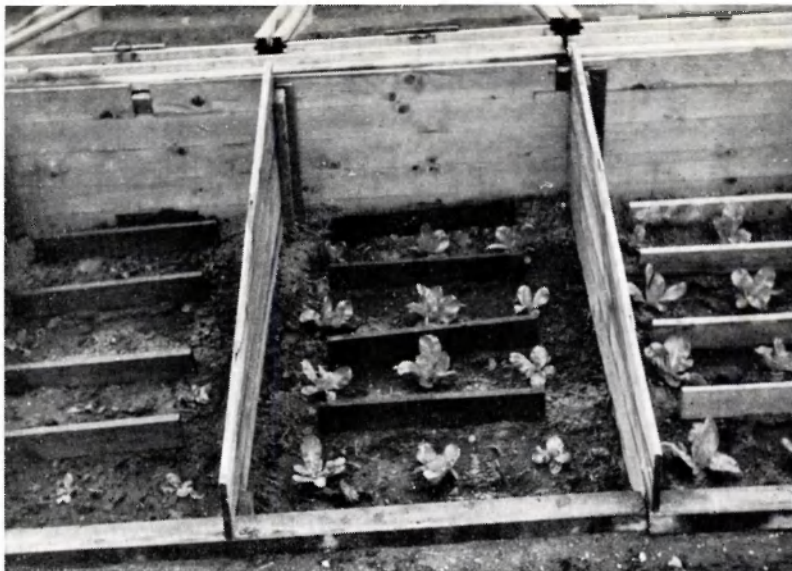
Beschadigingsproef met houtconserveringsmiddelen
