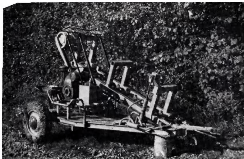
Gladiolenrooimachine (Corvallis, Oregon) (Uit Tuinbouwtechniek in Amerika)
