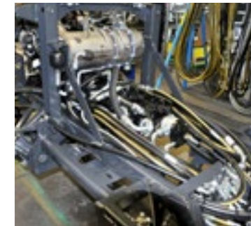
De techniek van een grote zelfrijdende maaier bestaat voor een groot deel uit hydraulische componenten. Bij deze F5 in wording zijn onder ander de rijmotor te zien en de beide hydro-motoren die de vijf klepelunits aandrijven. Bovenaan de katalysator voor Stage V-emissie-eis van de viercilinder Yanmar-motor.
