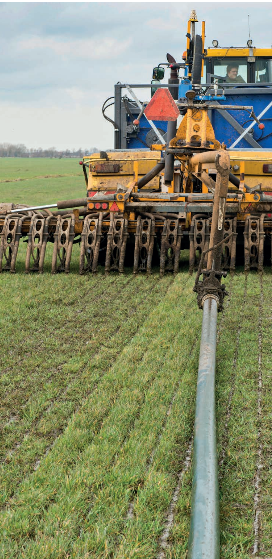
Water toevoegen aan de mest – zoals hier met de sleepslangbemester – geeft een ammoniakreductie van 40 procent bij uitrijden
