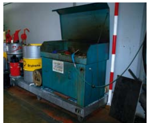
Hele goede oplossing: het gebruik van een lekbak.
