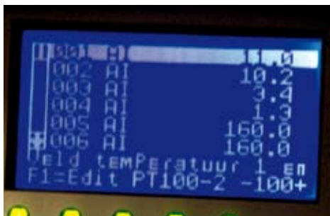
Display van de controle-eenheid, hier worden de veldtemperatuur en de buitentemperatuur afgelezen.
