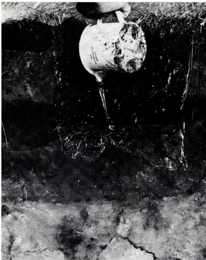
Fig. 4. Pouring-on nitro- cellulose lacquer
