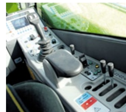
De kruishendel voor de bediening van de giek. Het linkerrolknopje is voor het telescoperen en het rechter voor het DW-ventiel op de giek.
