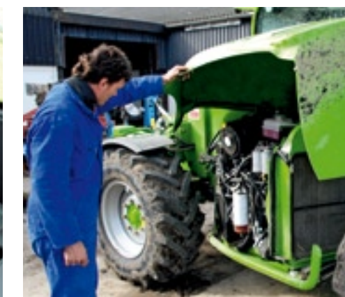
De motorkap gaat als één geheel open en dat is makkelijk bij het onderhoud. De motor kan aan de voorzijde iets naar buiten zwenken.
