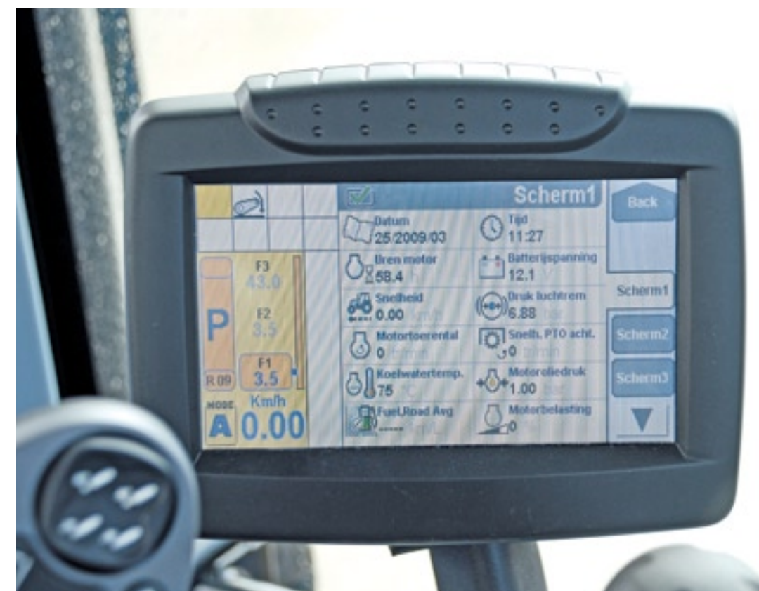
▲ Op het grote touchscreen kun je veel informatie kwijt over de trekker. Het blijft daarbij wel overzichtelijk en gemakkelijk door te bladeren. Het scherm doet tevens dienst als isobusmonitor.
