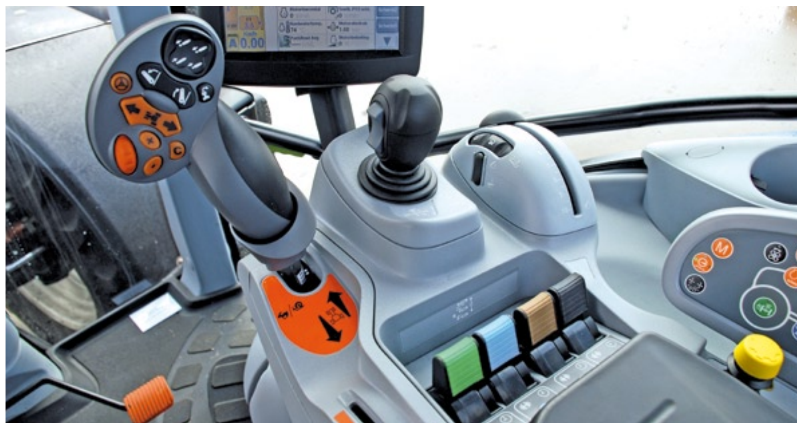
▲ De multifunctionele hendel laat zich eenvoudig bedienen als een echte rijhendel zoals je gewend bent van een hydrostaat. Wanneer je hem los laat, komt hij terug naar de middenstand. De bediening van alle veel gebruikte functies ligt binnen het bereik van de duim.
