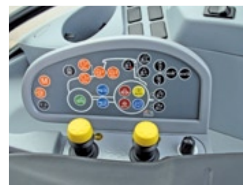
▲ Op het overzichtelijke Integrated Contol Panel (ICP) bedien je de diverse functies.
