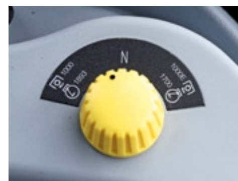
▲ Met een eenvoudige draaiknop kies je het toerental van de aftakas.
