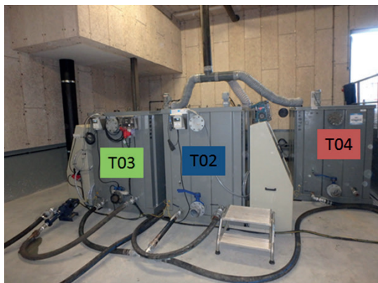
AFBEELDING 2.2 PILOTOPSTELLING KAUMERA-EXTRACTIE OP RWZI APELDOORN
