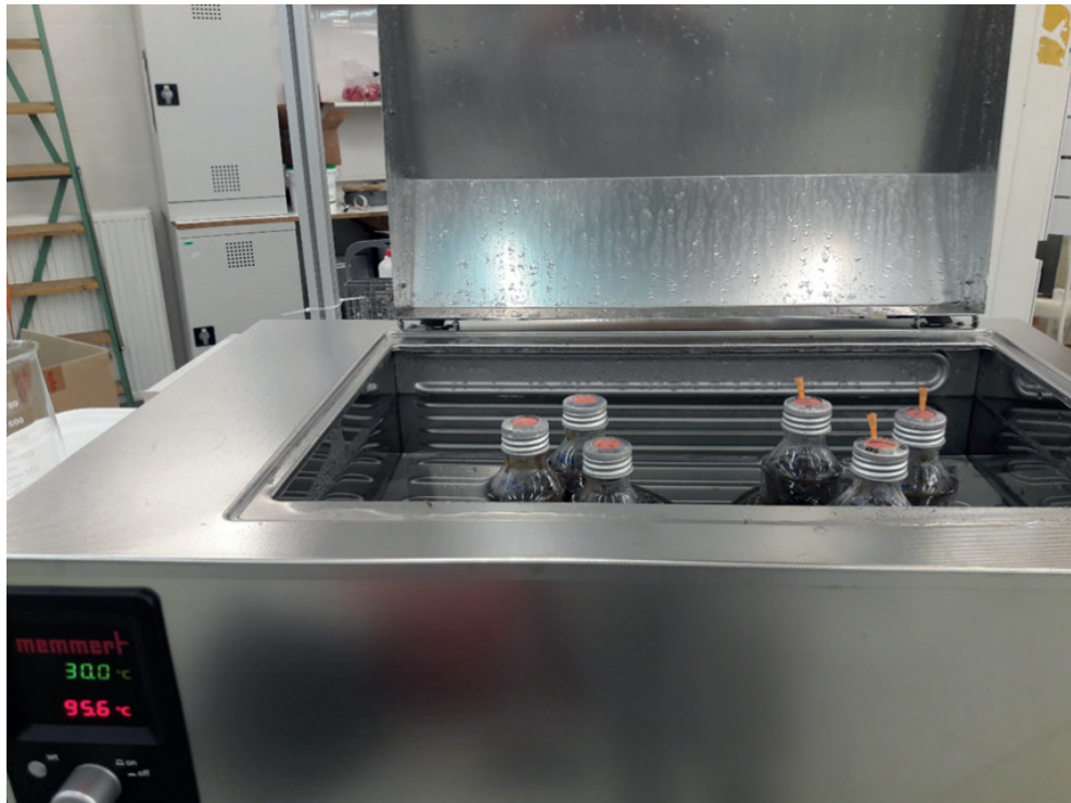
FIGUUR 3.3 OPSLAG VAN GEËXTRAHEERDE KAUMERA BIJ 30 C. LINKS: AFGESLOTEN FLESJES ZONDER ZUURSTOF (HEADSPACE GEFLUSHT MET STIKSTOFGAS, RECHTS: OPEN VERBINDING MET DE LUCHT VIA EEN NAALDJE DOOR HET SEPTUM)
