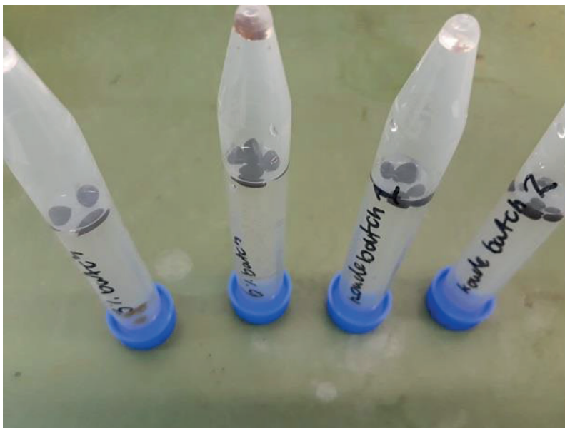
AFBEELDING 3.3 GELVORMING VAN KAUMERA MET CALCIUM (BRON RHDHV)
