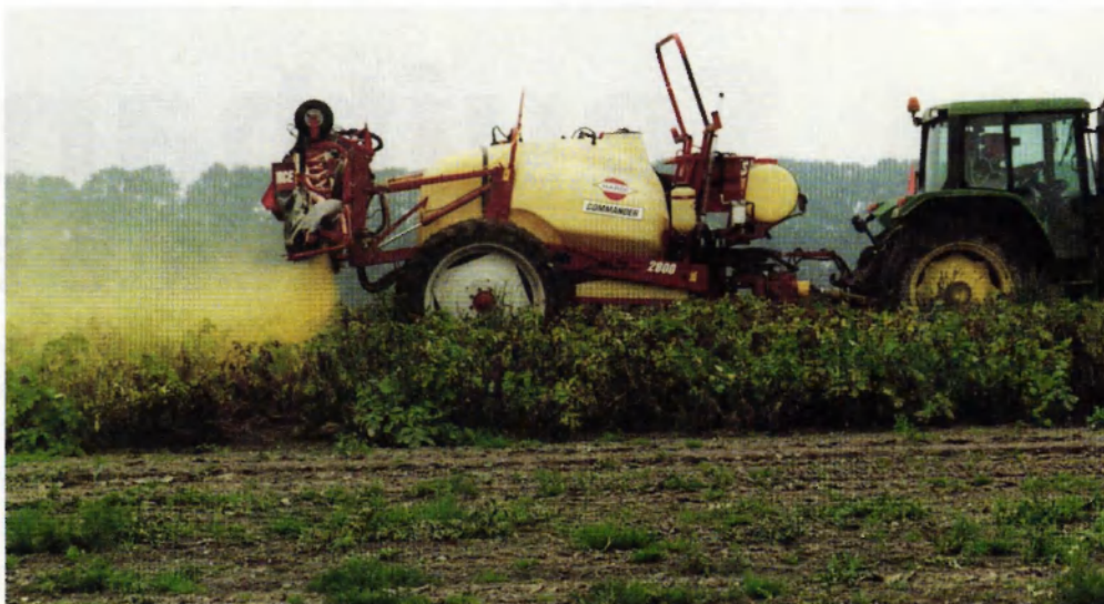
Door doppen te gebruiken met een grover druppelgroottespectrum en met luchtondersteuning kan deze drift flink gereduceerd worden.
