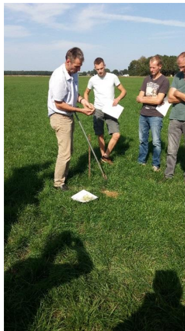
Figuur 3: Op vier plekken waar volgens de dronemetingen verschillen zichtbaar waren, stak Albert Jan Bos met de grondboor monsters op verschillende dieptes en keken we of we de verwachte resultaten zouden zien.
