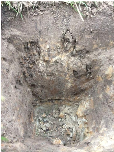
Figuur 12: Veel ijzer in het lemige bodemprofiel wijst op een matige waterdoorlatendheid
