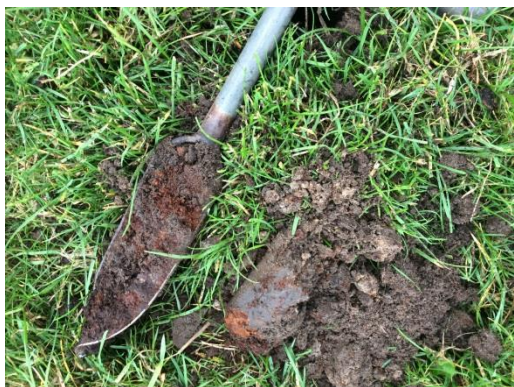
Figuur 11: Veel ijzer in de gemengde bovengrond wijst op een matige waterdoorlatendheid
