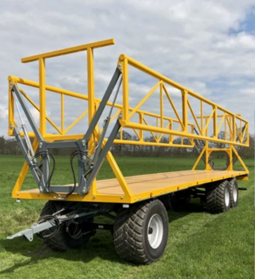
Naarmate de parallelarmen dichter naar het midden van de wagen bevestigd zijn, wordt het hoogtebereik van het hek groter. Hier de wagen van Tjalma.
