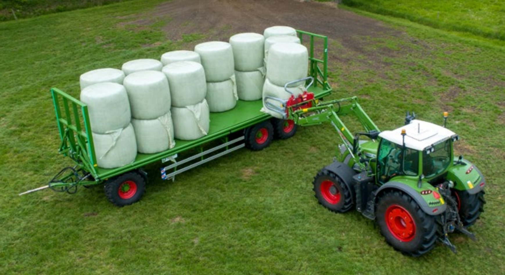
Met twee buizen die bij het openen samenvouwen op laadvloerhoogte is er veel bewegingsvrijheid bij het laden en lossen. De constructie van de borging is relatief eenvoudig en de krachten die er op het frame komen zijn beperkt. De lengte van de laadvloer is in dit geval 6,5 maal de diameter van de baal. De vloer is 2,5 meter breed.
