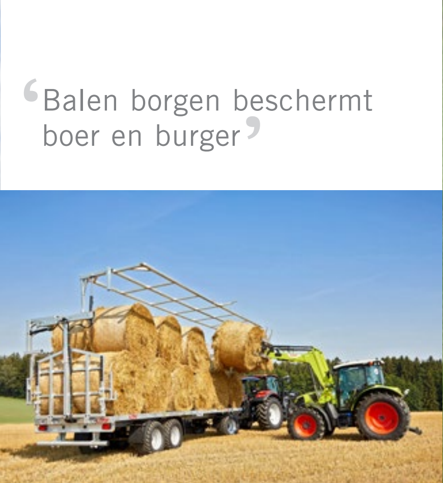
Zelfborgende balenwagens hebben vaak een vooras (aan een draaischamel) en één of twee achterassen. De wagen staat op zichzelf. De trekker kan ook laden.
