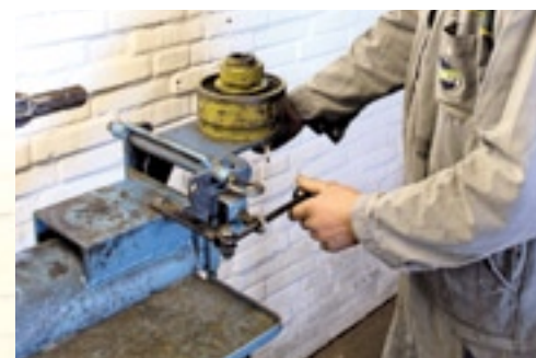
▲ De nokkenasslipkoppeling is aan de werkbank geschroefd.
