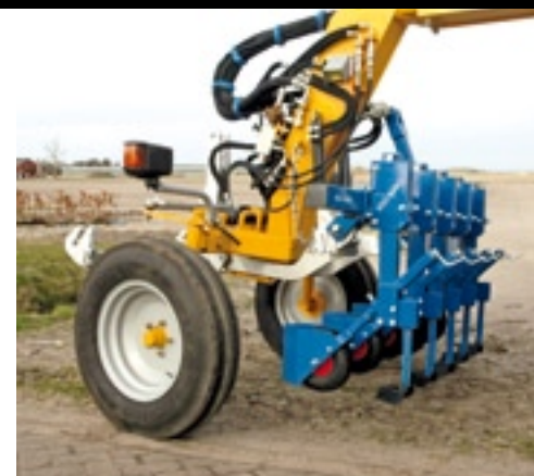
De Mazzotti is zowel met 2wd als met 4wd leverbaar. De draaicirkel is met 4wd niet groter doordat de voorloop in een bocht toeneemt.
