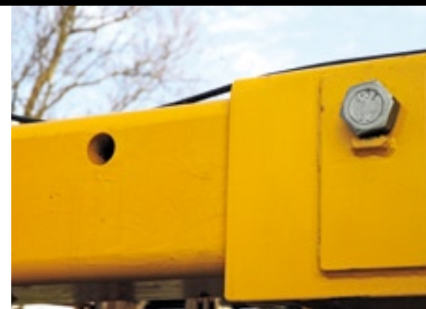
De lengte van de centrale boom is in stappen van 15 cm te variëren over een afstand van 60 of 120 cm. Tegen meerprijs kan dat hydraulisch.
