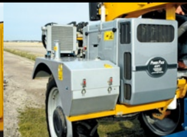
Het 'powerpack' bestaat uit een viercilinder Perkins en een oliepomp van Sauer. De wielmotoren (bij 4wd zijn er dat vier) zijn van Poclain.
