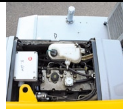
De Perkins ligt voor de achteras langs de centrale boom en zit dus redelijk centraal. Boven in beeld de brandstoftank en rechts de oliekoeler.
