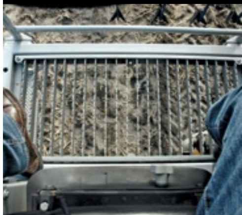
De cabine-loze Multi heeft een rooster als voetenplaat; dat geeft een onbelemmerd zicht. De glasplaat in de cabineversie kan vuil worden.
