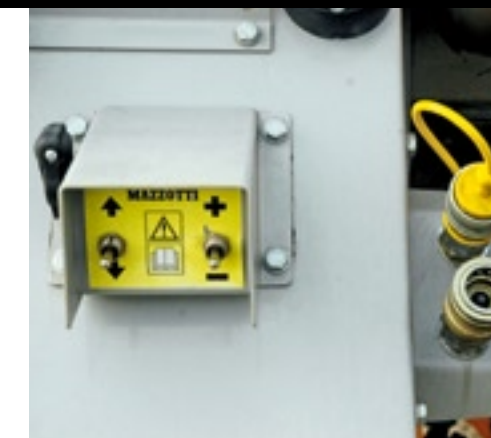
De hefinrichting is voor het aankoppelen vanaf de grond te bedienen. De hydrostatische aftakas achter kan via een schakelaar iets draaien.
