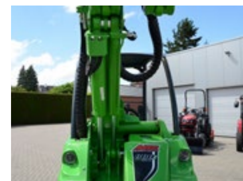
De hulphefcilinder voor de parallelgeleiding is bij de 860i onder de boom weggewerkt.
