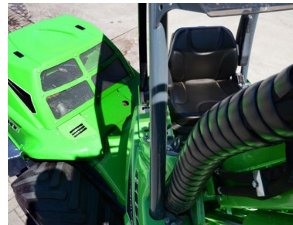
Het bestuurdersplatform voor de knik heeft het voordeel van een perfect zicht op de giek. Nieuwe chauffeurs zullen er even aan moeten wennen.
