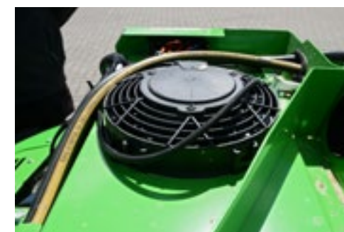
De elektrische ventilator van de intercooler ligt plat onder de motorkap.
