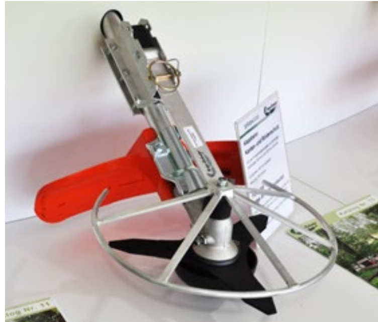
Deze opklapbare beschermbeugel voor de bosmaaier is van Schmidt in MÜNnerstadt en is verkrijgbaar via Kramp. De diameter is 330 mm.
