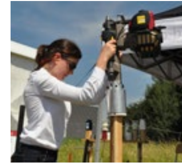
Deze palenrammer komt uit Australië. Op basis van een Honda GX35 viertakt-benzinemotor van 1,3 pk zorgt hij voor 1.720 slagen per minuut. Hij weegt met een vol tankje bijna 16 kg en kost volgens leverancier Geo-bil uit Freiburg exclusief btw 1.727 euro. Met verschillende adapters is hij geschikt voor palen tot 100 mm doorsnede.
