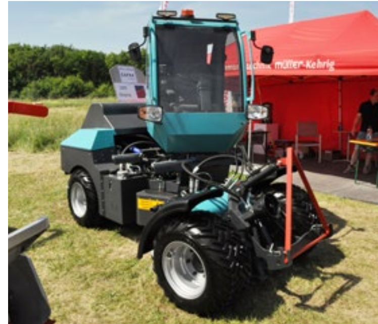
Deze Janus van de firma Konrad Adler uit Wolfegg kan rijdend in hondengang hellingen aan tot 45 graden en houdt daarbij de draaibare cabine rechtop.
