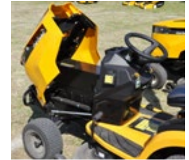
Zitmaaiers met accu-aandrijving, zoals deze XT2 van Cub Cadet, verschillen op het eerste oog nauwelijks van de benzineversie. De XT2, die 107 cm breed pakt, komt volgens de fabrikant volgend voorjaar op de markt. De maaier heeft een lithium-ionaccu.
