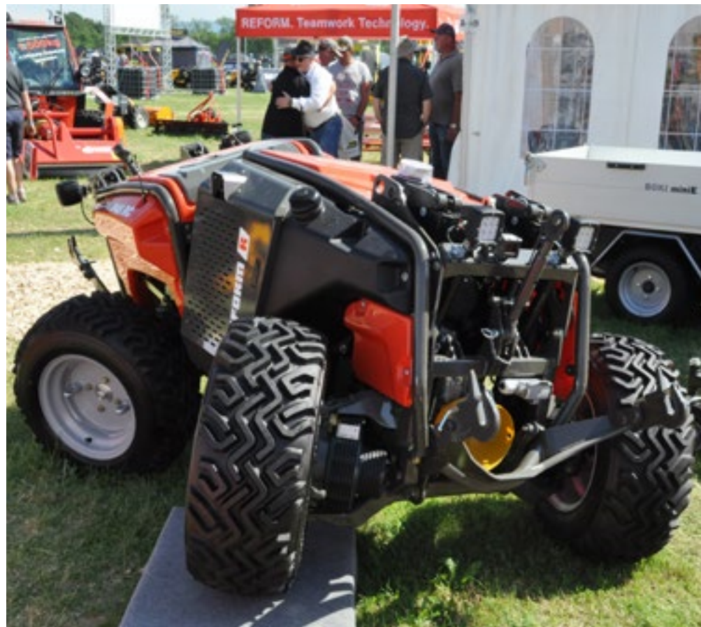
De Metron P48 RC Hybrid van Reform wordt radiografisch bestuurd. De 48 pk sterke benzinemotor drijft een generator aan die vervolgens de elektromotoren in elk van de vier wielen aandrijft. Ook de aftakas wordt elektrisch aangedreven. Het werktuig kan ook in hondengang rijden.
