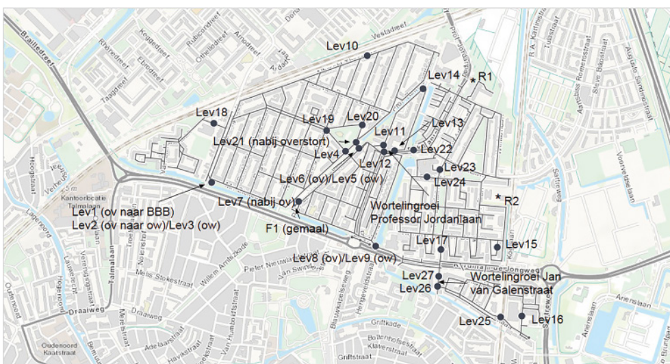
Figuur 3.1 Meetnet rioolstelsel Tuindorp. Het meetnet bestaat uit een debietmeting (F1), twee neerslagmeters (R1 en R2) en niveaumetingen (Lev1 tot en met Lev27) in inspectieputten, bij overstorten (ov) en in het oppervlaktewater (ow)
