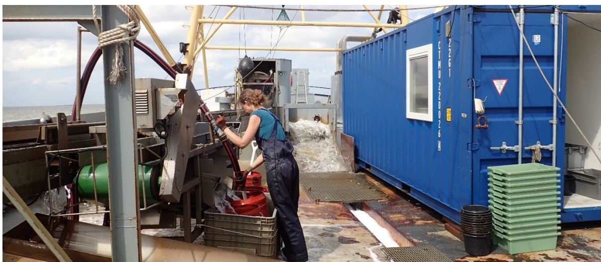
Figuur 4. Het zeven en spoelen van een monster aan boord van de YE42. Met rechts op de foto de mobiele labruimte waarin de monsters verder verwerkt worden.
