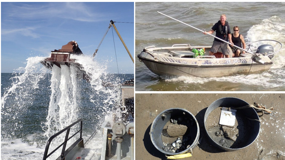
Figuur 3. De meest gebruikte monstertuigen: stempelkor (links), kookelschepje (rechtsboven) en steekbuis met zeef (rechtsonder).
