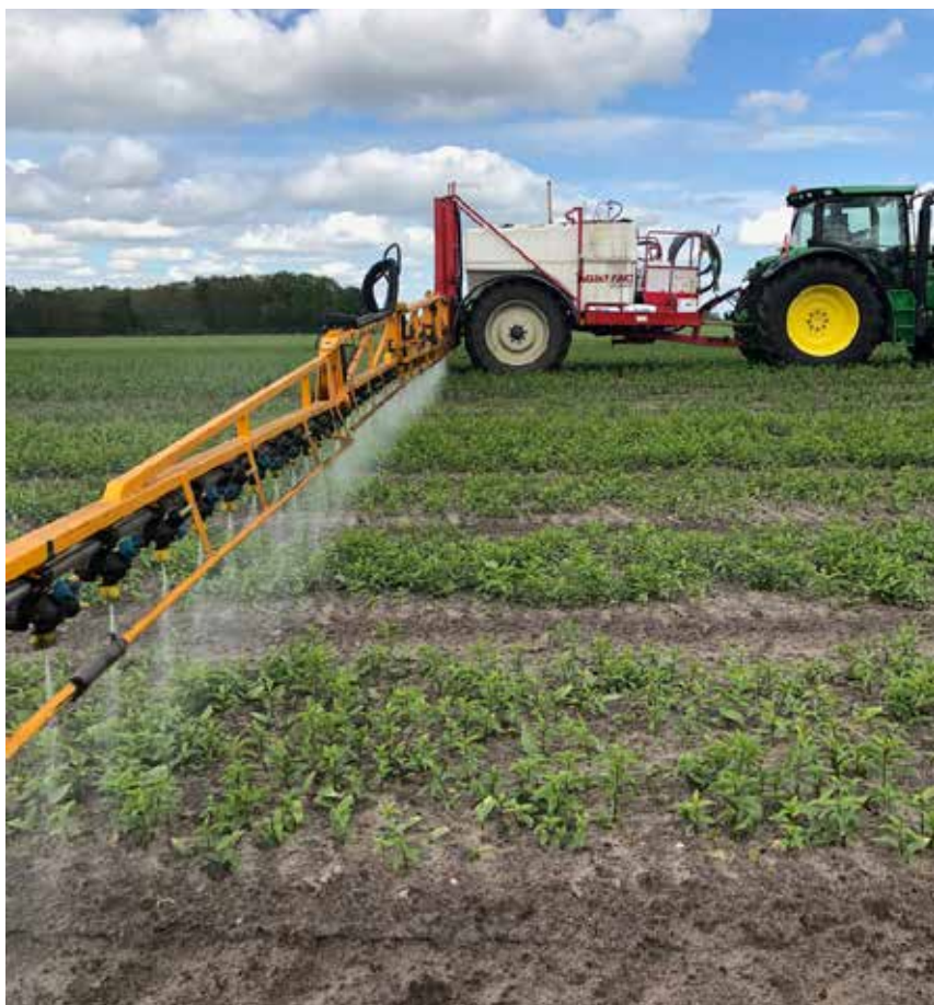
Figuur 5: Landbouwbedrijf Fernhout uit Smilde heeft geïnvesteerd in twee veldspuiten met verlaagde spuitboom en dopafstand van 25 cm i.p.v. 50 cm. Op die manier verminderen ze de drift.
