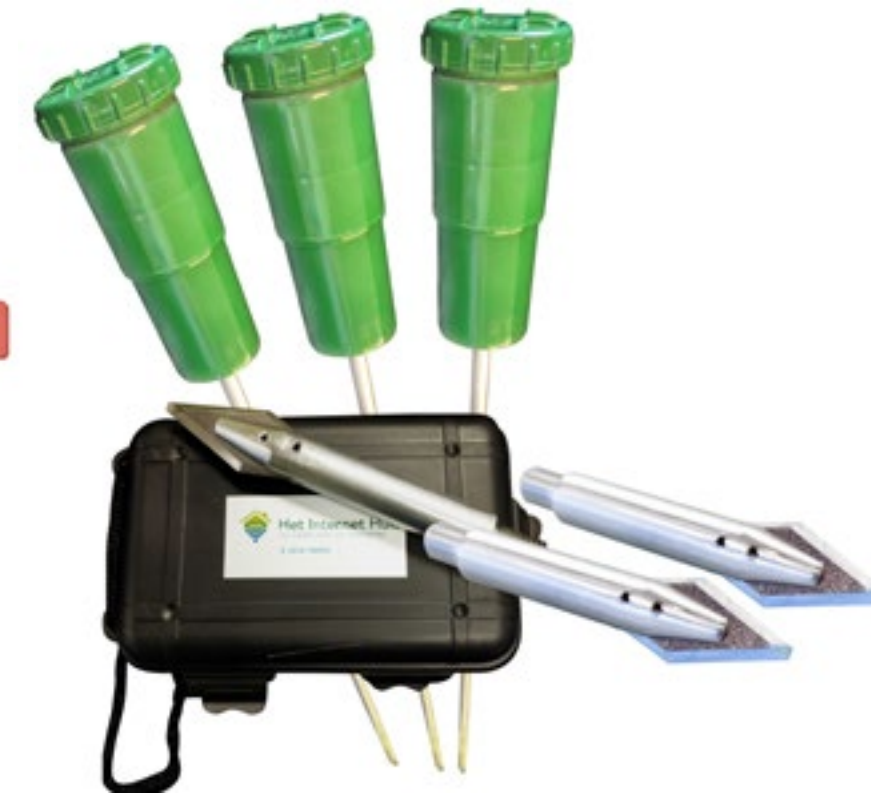
De detectieset van Het Internet Huis bestaat uit drie sensoren. De groene module bovenop de stick stuurt de meetwaarden door naar de mobiele applicatie.
