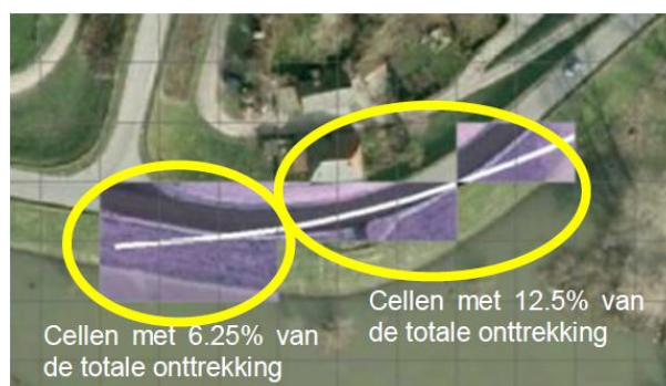
Figuur 9.21 Modellerings van het DMC systeem met een vaste onttrekking. De rekencellen in het paars hebben een vaste onttrekking (van der Linden, 2014)
