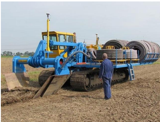
Figuur 6.2 Links: Aanbrengen drainage via v-ploeg (foto Barth drainage), rechts: aanbrengen drainage kettinggraver (foto: Boersma drainage)
