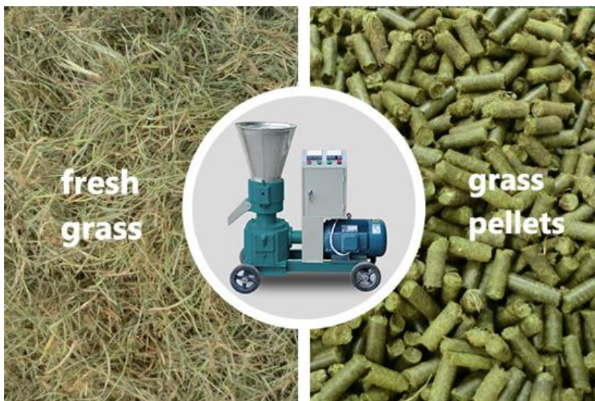
Figuur 4 Pelletiseren; overgenomen uit TICO (z.j.)
