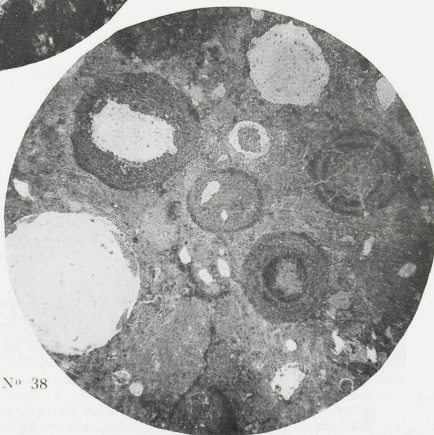
Photo N° 38 - BALEKO - Bauxite « kaolinique » (L.N. × 60) : Sub- stance amorphe dans les oolites et dans les méats ; quelques fissures tapissées de gibbsite.
