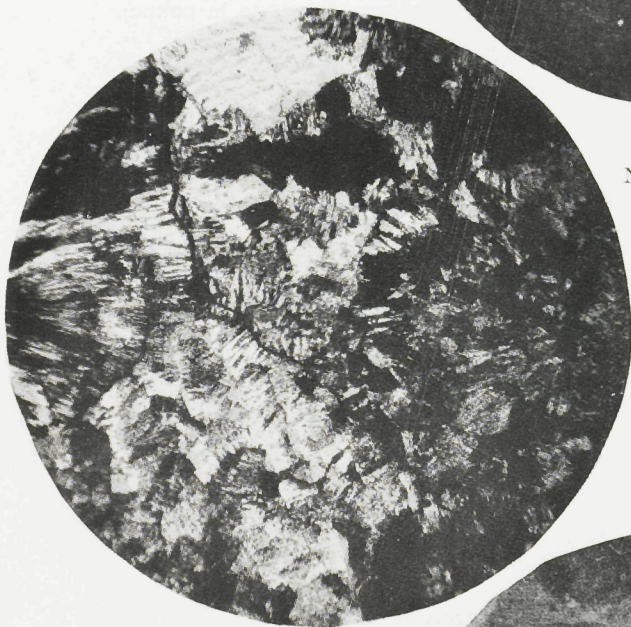
Photo N° 37 - LAKOTA - Même échantillon (L.P. × 125) : Détail sur les cristaux de gibbsite, avec macles visibles.
