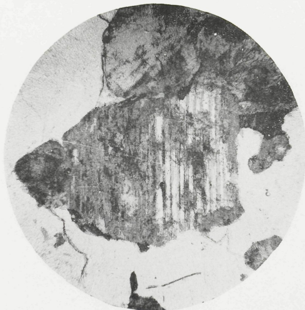
Photo N° 26 - MACENTA - Même échantillon (L.N. \times 60 ) : Dans l'oligoclase, les plages altérées sont troubles, pénétration d'hydroxydes de fer dans les fissures et dans les clivages.
