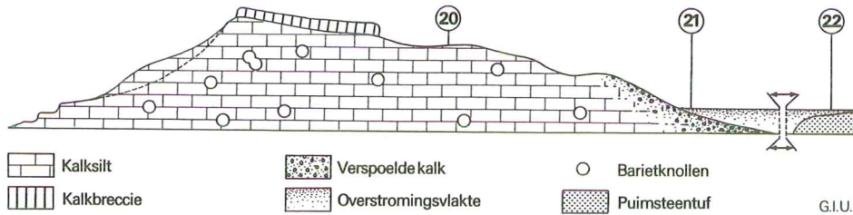
fig. 7.10 Schematisch dwarsprofiel over Voorbeeldgebied 4 met daarin aangegeven de locaties van de pedons
