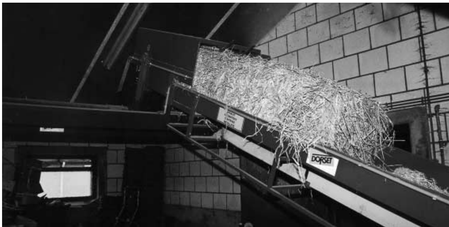
De balensplitter zorgt voor het snijden van strobalen en het doseren in het transportsysteem
