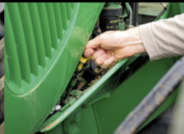
▲ Om olie te peilen moet je een zijpaneel wegklappen.
