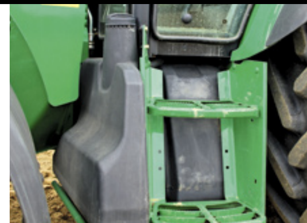
▲ Aan de linkerkant van de trekker hangt de brandstoftank van 130 liter. Een tank van 150 liter is een optie.
