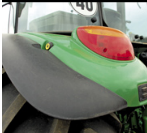
▲ De hef, maar ook de aftakas, laten zich op beide achterspatborden bedienen.
