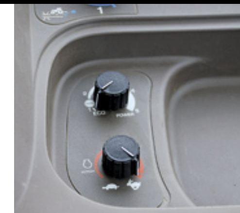
▲ Er is een cruisecontrolfunctie (boven) en een knopje waarmee je het schakelmoment van de automatische powershift instelt.
