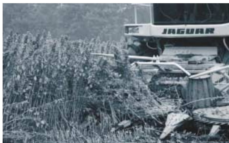
Oogst met maishakselaar met rijonafhankelijk voorzetstuk
