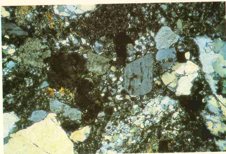
A — Conglomerado polimítico (Formação Aprazível). Fotomicrografia LP-2,5X, amostra 264-AG-73. Clastos de arenito, silto, feldspato e quartzo, imersos em matriz areno-argilosa. Aspecto de cristais de epidoto englobando grãos detritais. Folha SA.24-Y-C.
