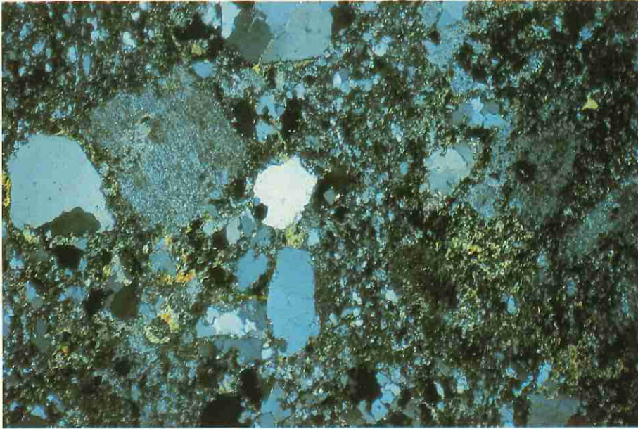
A — Dacito (Vulcanismo Parapui). Fotomicrografia LP-2,5X, amostra 212-DN-09. Aspecto de textura heterogranular cataclástica contendo fenoclasto de oligoclásio alterado, quartzo e hornblenda em matriz cataclástica composta por plagioclásio, quartzo, hornblenda e acessórios. Folha SA.24-Y-D.
