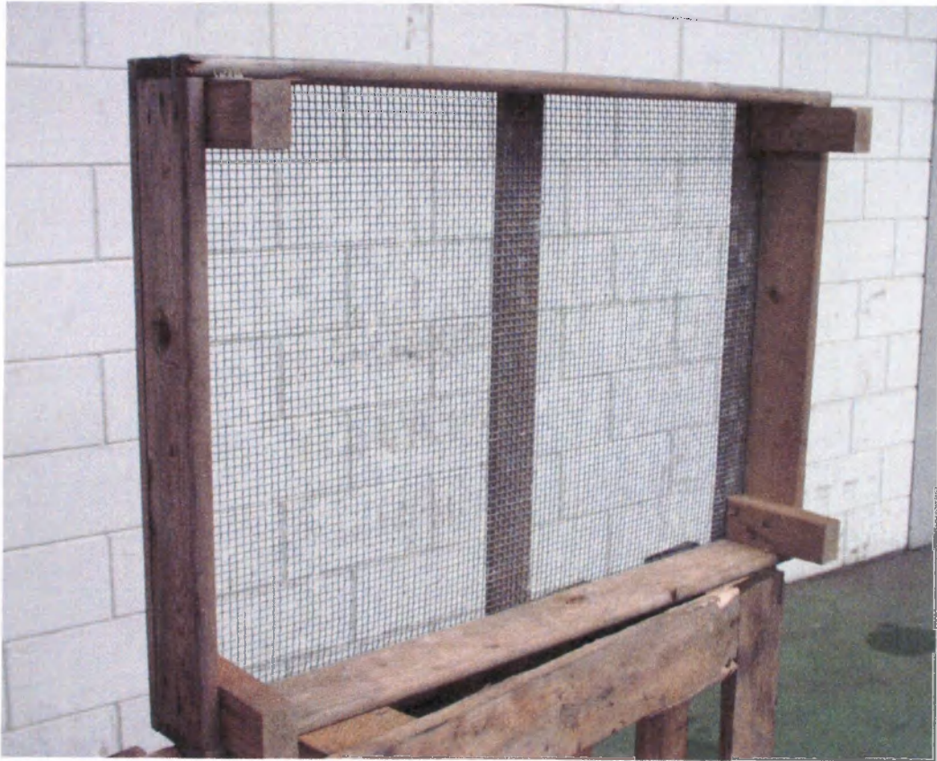
Fig. 13, de luchtdoorlatende bodem van een gaasbak.
