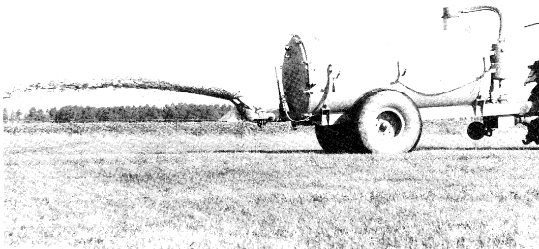
Bij de berekeningen is uitgegaan van uitrijden van aangezuurde mest met een ketsplaat
