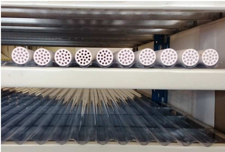
Figuur 1: Gloednieuwe keramische nanofiltratie membranen in laboratorium van het Fraunhofer instituut.
