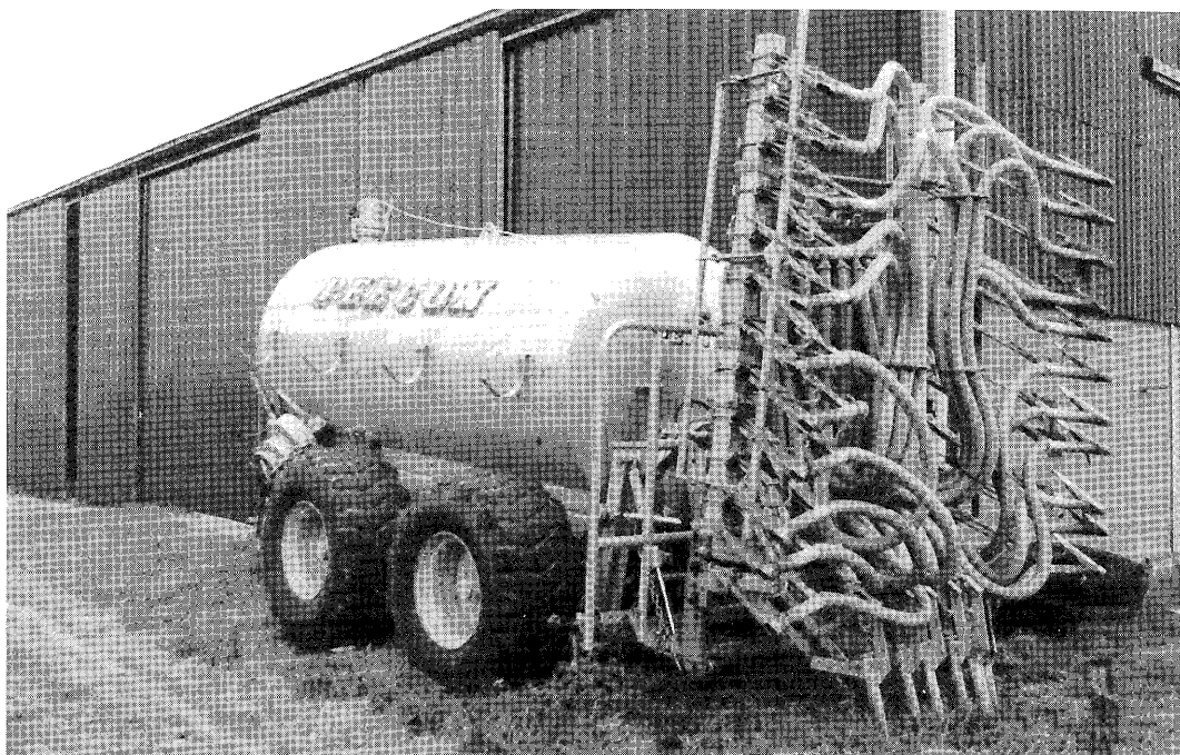
Met een sleevoetenmachine wordt circa 75% van de fosfaat in de mest benut voor de eerste snede
